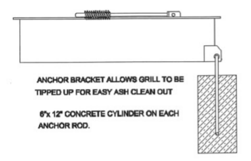
NOTE: THE SIZE OF THE CONCRETE FOOTING IS ONLY A SUGGESTION YOUR LOCAL SOIL CONDITIONS SHOULD DETERMIN WHAT IS NEEDED
